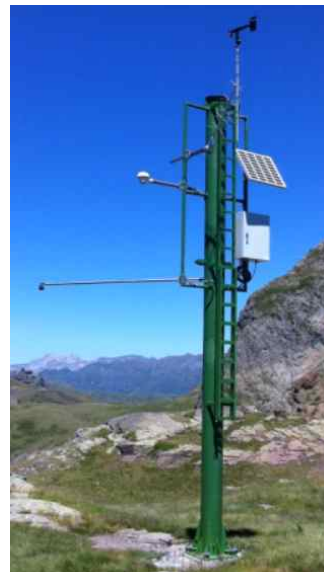
[그림 99] WMO-No.8 Volume 2에서 제시된 경사면에서 적설 두께(D)와 적설 깊이(HS)의 관계(좌), 초음파 적설계 모습(우)
