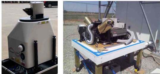
그림 3.3. 미국 해양대기청(NOAA) 이동형 하층 대기 프로파일링 시스템(CLAMPS, Collaborative Lower Atmospheric Mobile Profiling System) 측정장비. (왼쪽) 바람장 연직구조 관측을 위한 도플러 라이다. (가운데) 온도 및 습도 연직 관측을 위한 대기 복사 분광계. (오른쪽) 구름 조건에서도 온도 및 습도 관측이 가능한 마이크로파 라디오미터
